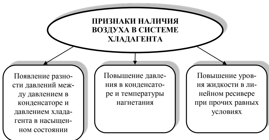
Рисунок 27 – Характерные признаки наличия воздуха в системе хладагента холодильной установки
