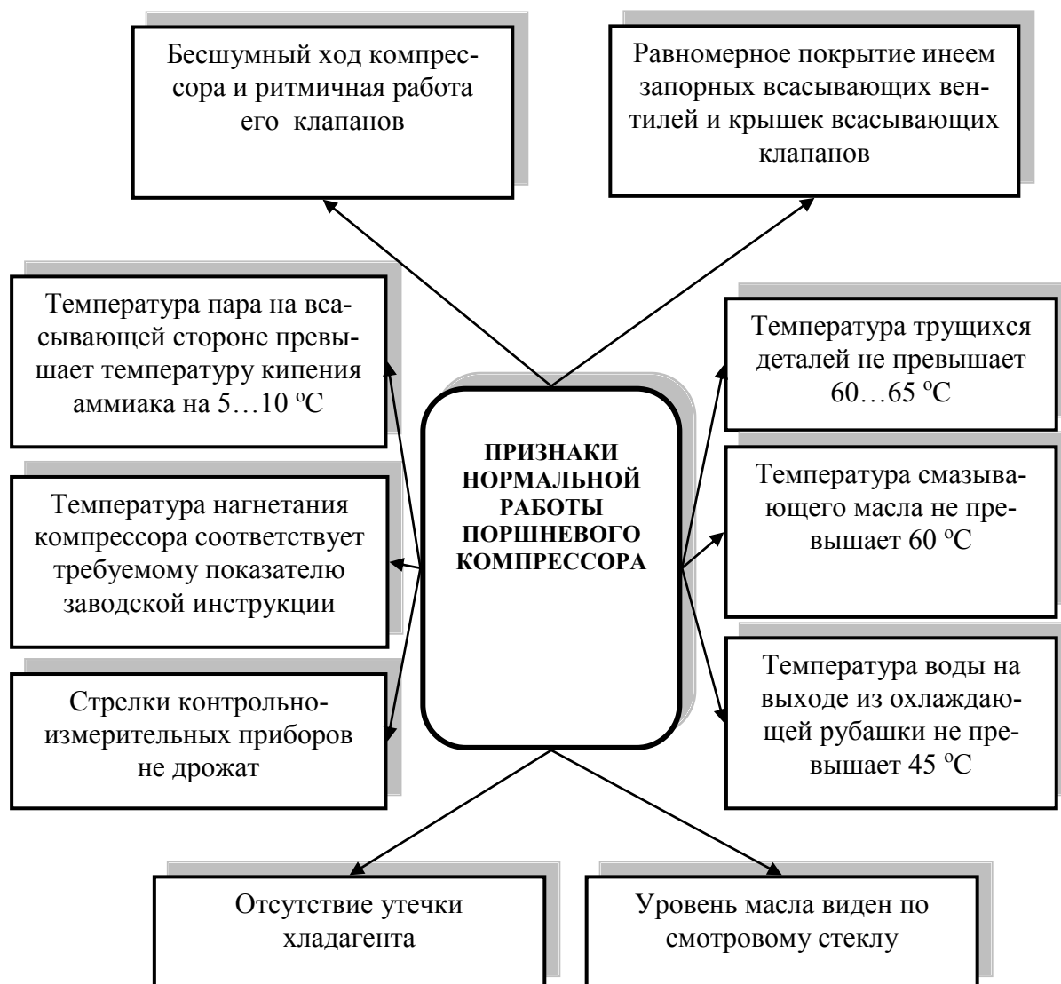
Рисунок 25 – Показатели (признаки) нормальной работы поршневых компрессоров
