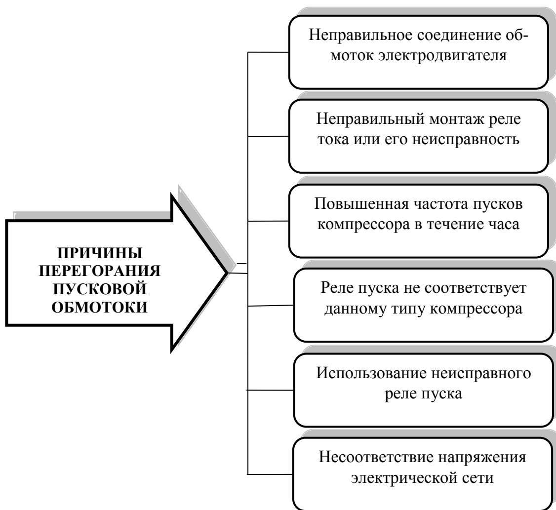
Рисунок 26 – Основные причины сгорания пусковой обмотки электродвигателя компрессора
