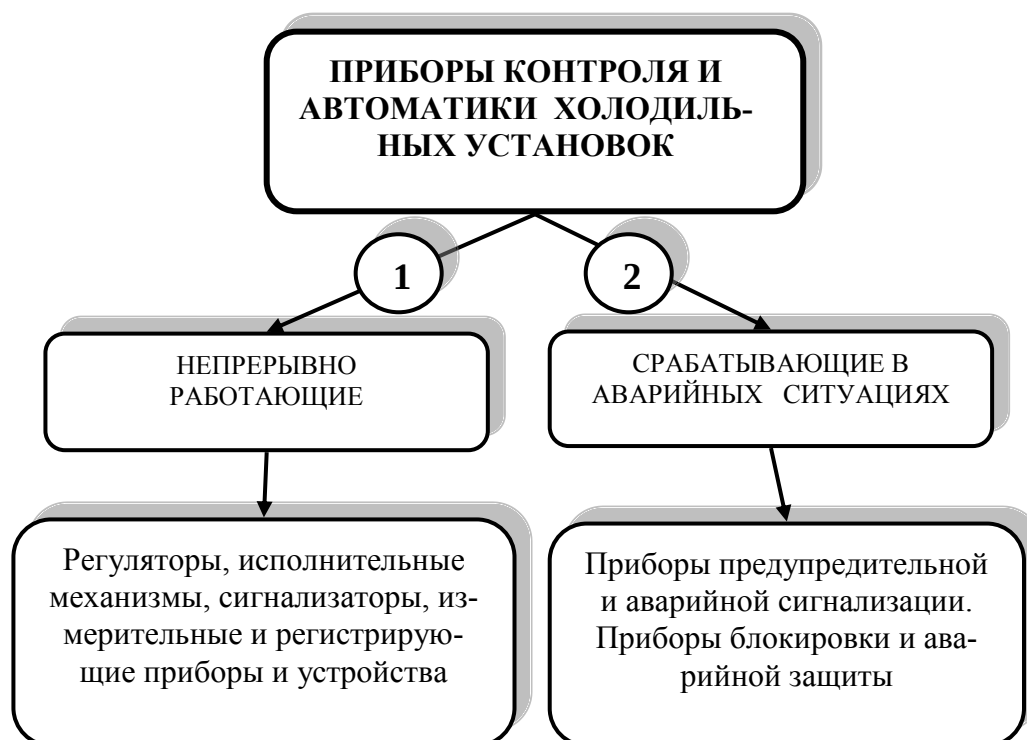
Рисунок 29 – Классификация приборов контроля и автоматики холодильных установок
